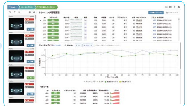
▲画像の登録からモデルの学習、精度比較までを一気通貫で管理できるGUI 学習ツールを用意
