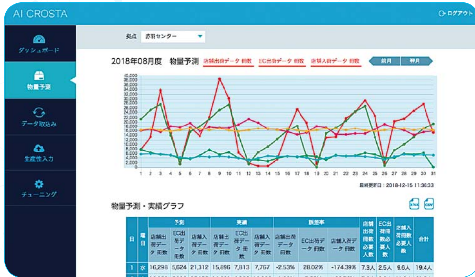
▲AI CROSTAによる物量予測(上段は物量予測・実績グラフ、下段は上段の表での表示)
