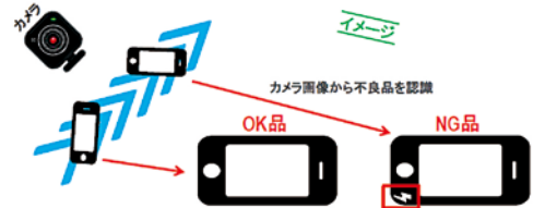
▲製品のキズ検知モデルを開発し、欠損品の自動検出を可能に
