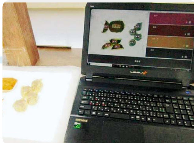
▲AIによる画像認識でギョーザやシューマイ、コロッケ等を瞬時に判別する
